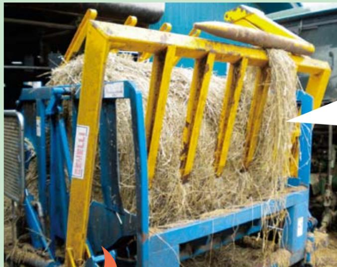
写真3：自給粗飼料を細断するために導入したカッティングロールペーラー
