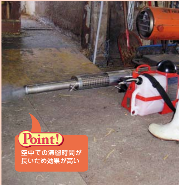
写真2：煙霧消毒器による消毒
