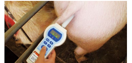
深部腔内電気抵抗値による測定状況 ※ブリードテスト PIT-1(全農畜産サービス株)
