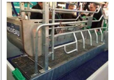
圧死防止装置(母豚の場所が上下する)分娩舎での事故率軽減策として、いかに圧死を減らせるかが重視されていることの表れである
