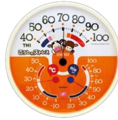
子牛用に、寒冷ストレスについて表示しているメーターもある。子牛の健康と発育に影響する牛舎環境、暑熱・寒冷対策の目安を手軽に知ることができる
