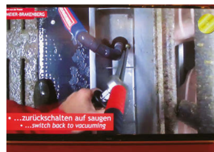
写真1. リキッドフィーディング用洗浄ノズル (Euro Tier金賞)
