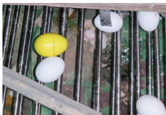
図2. 集卵工程上の衝撃センサー
