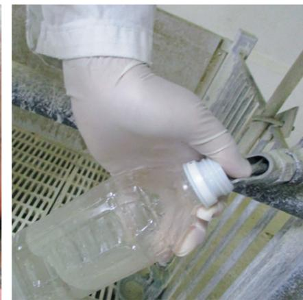
ペットボトルを用いたピッカーの水量チェック
