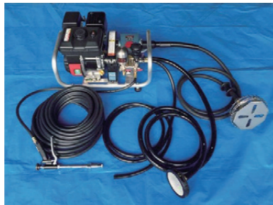
科学飼料研究所と協力して改良した散布機(ガンズル付)
