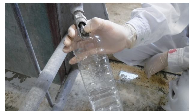
写真2. ペットボトルを用いて流量を測る
