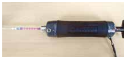
写真4 気体検知管(気体の濃度の確認)
