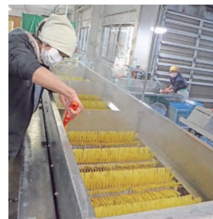
写真3. 洗卵ブラシの検査では、心棒部分の洗浄が十分でないことが判明。意識して洗浄することにしました。
