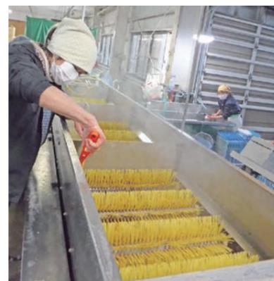
写真3. 洗卵ブラシの検査では、心棒部分の洗浄が十分でないことが判明。意識して洗浄することにしました。
