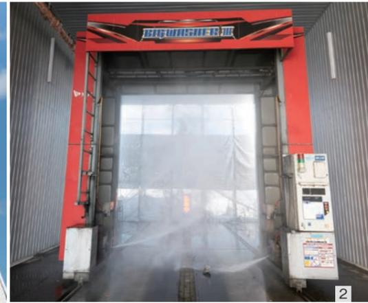
①乗用車からトラックまで対応している特注の大型洗浄庫 ②車両の両サイド、下まわりを徹底洗浄
