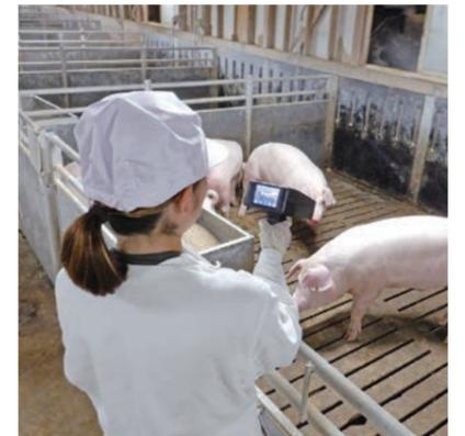
少ない労力で肥育豚の体重を推定できます(写真1、2)。装置上部の立体カメラで豚を撮影し、豚の立体データを取得すると、撮影から約4秒後に体重推定値が表示されます。
