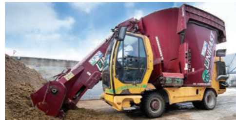
必要な量だけ 自動で粗飼料を集める 自走式混合飼料ミキサー
