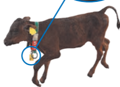
タグは小型で軽量。振動発電により電池交換は不要
