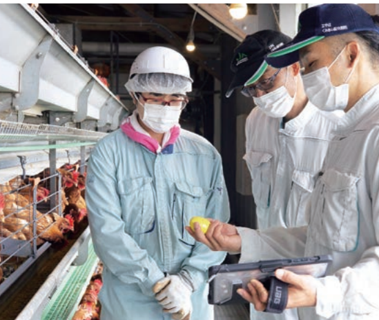
ケージ前でコンベアのつながり部分の衝撃などを確認
