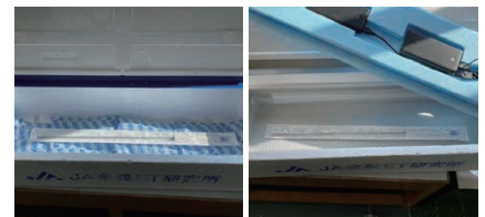
図5 簡易的な移植器保温箱(左)とヒーターを備えた加温箱(右)
