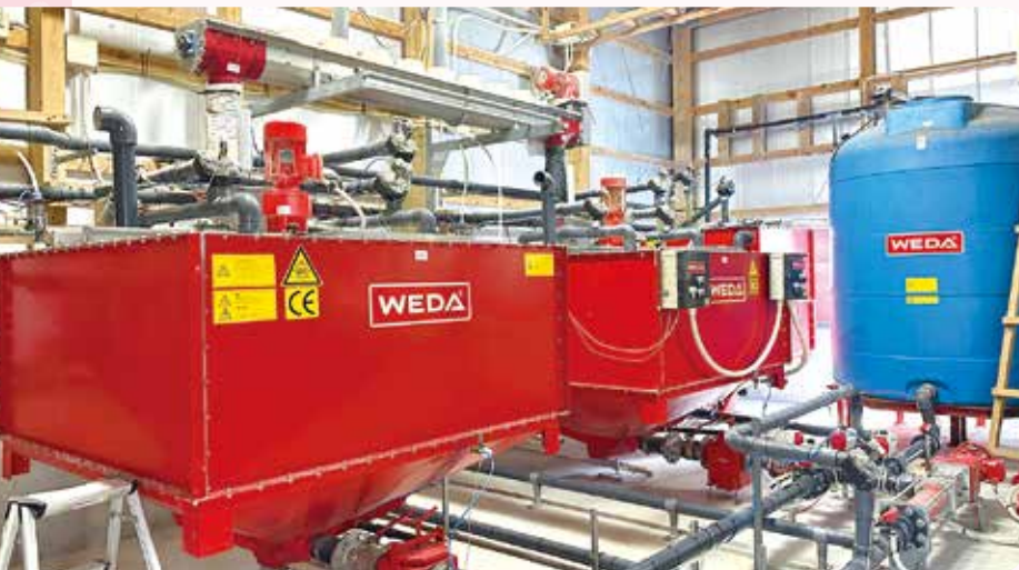
液状飼料を作成する給餌システムのリキッドフィーディングシステム(LFS)
